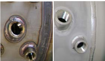
Schweißnaht ungebeizt, Material 1.4571
