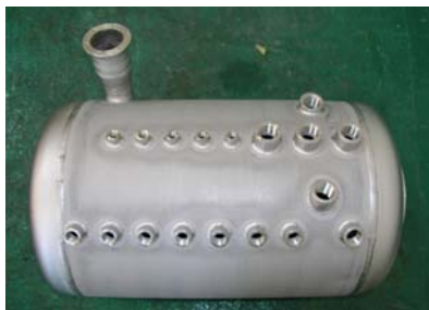
Tartály HC700-zal kémiailag pácolva és passzíválva
