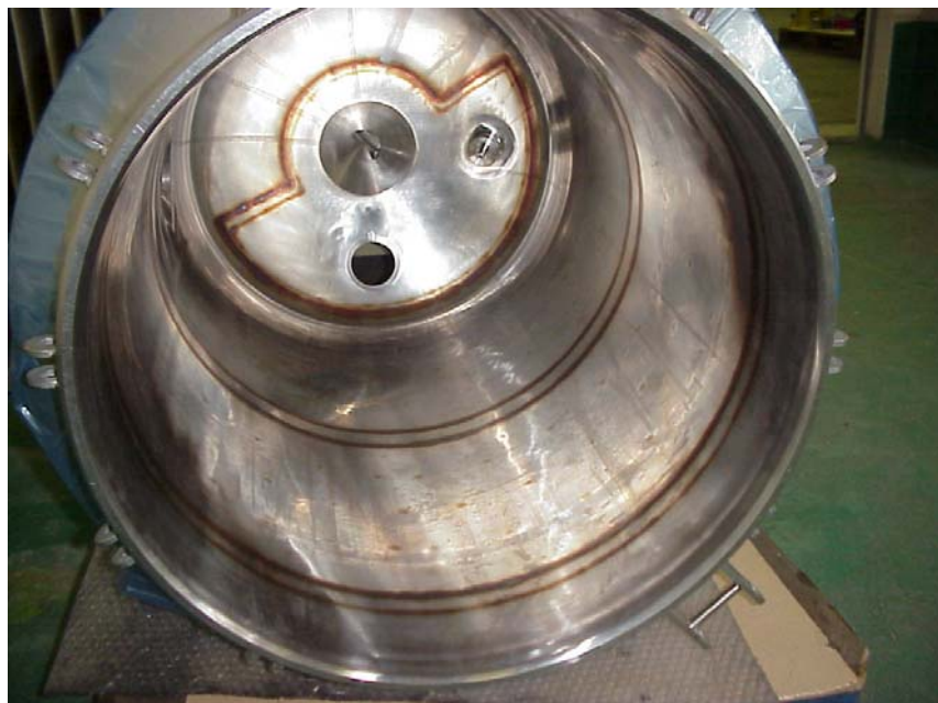
Bild 1: leichte Colorierung der HEZ (WIG-Schweißung)
