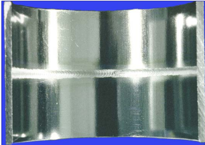
Elektropoliertes Rohr 50,8 × 1,65 mm, AISI 316L, Formiergas Argon (8 ppm Restsauerstoffgehalt)
